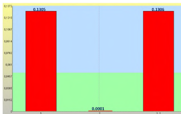
Рис. 4.26 Риск критичного нарушения ПБ за сутки при полном бездействии в задаче 2-4.4.7.1 (1- за 1-ю подсистему, 2- за 2-ю подсистему, 1...2 – за систему в целом)
