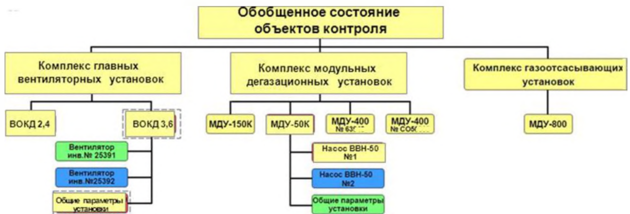
Рис. 4.28 Все объекты контроля в состоянии «условное обеспечение ПБ» («желтый») и «штатное обеспечение ПБ» («зеленый»), плюс резерв
