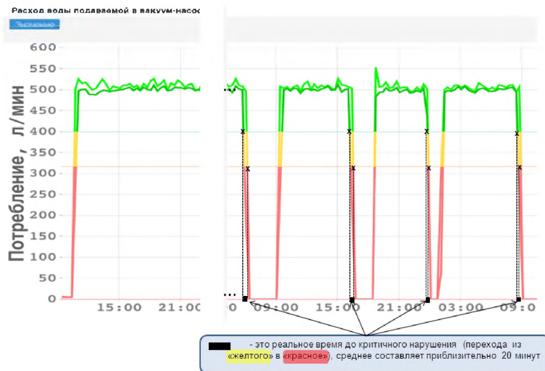
Рис. 2.18 Оценки ожидаемого времени для оперативного восстановления целостности контролируемого оборудования по видеоданным
