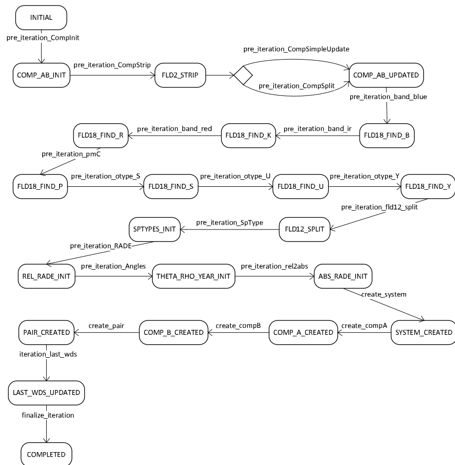
Рисунок Б.2 – Граф состояний и переходов программы интеграции
