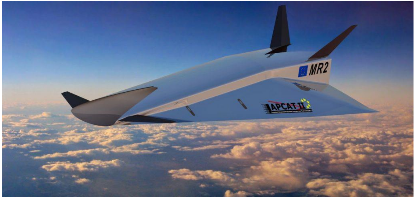
Рисунок 4.1 – Малоразмерный демонстратор высокоскоростного ЛА MR2 который исследовался в рамках проекта HEXAFLY–INT [181]
