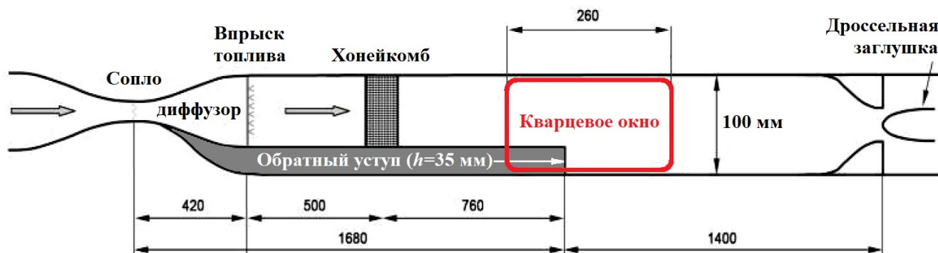
Рисунок 10 – Схема установки ONERA A3C (Magre, Moreau, 1988)
