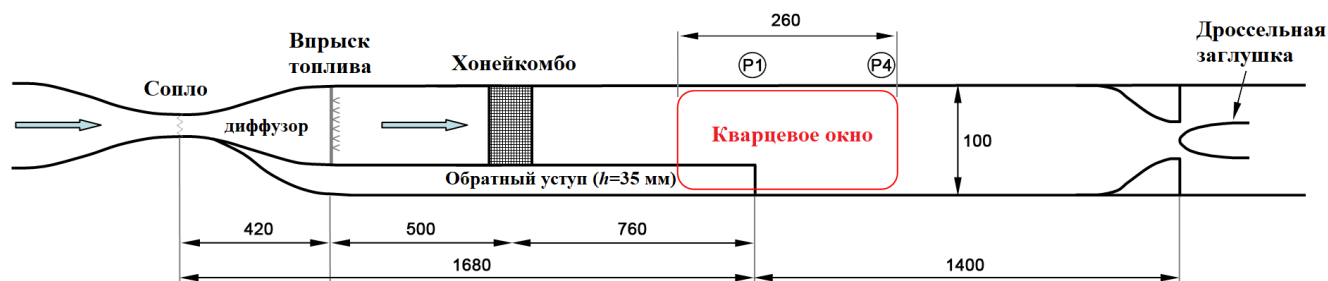
Рисунок 4.1 – Схема экспериментальной модели ONERA/LAERTE с уступом
