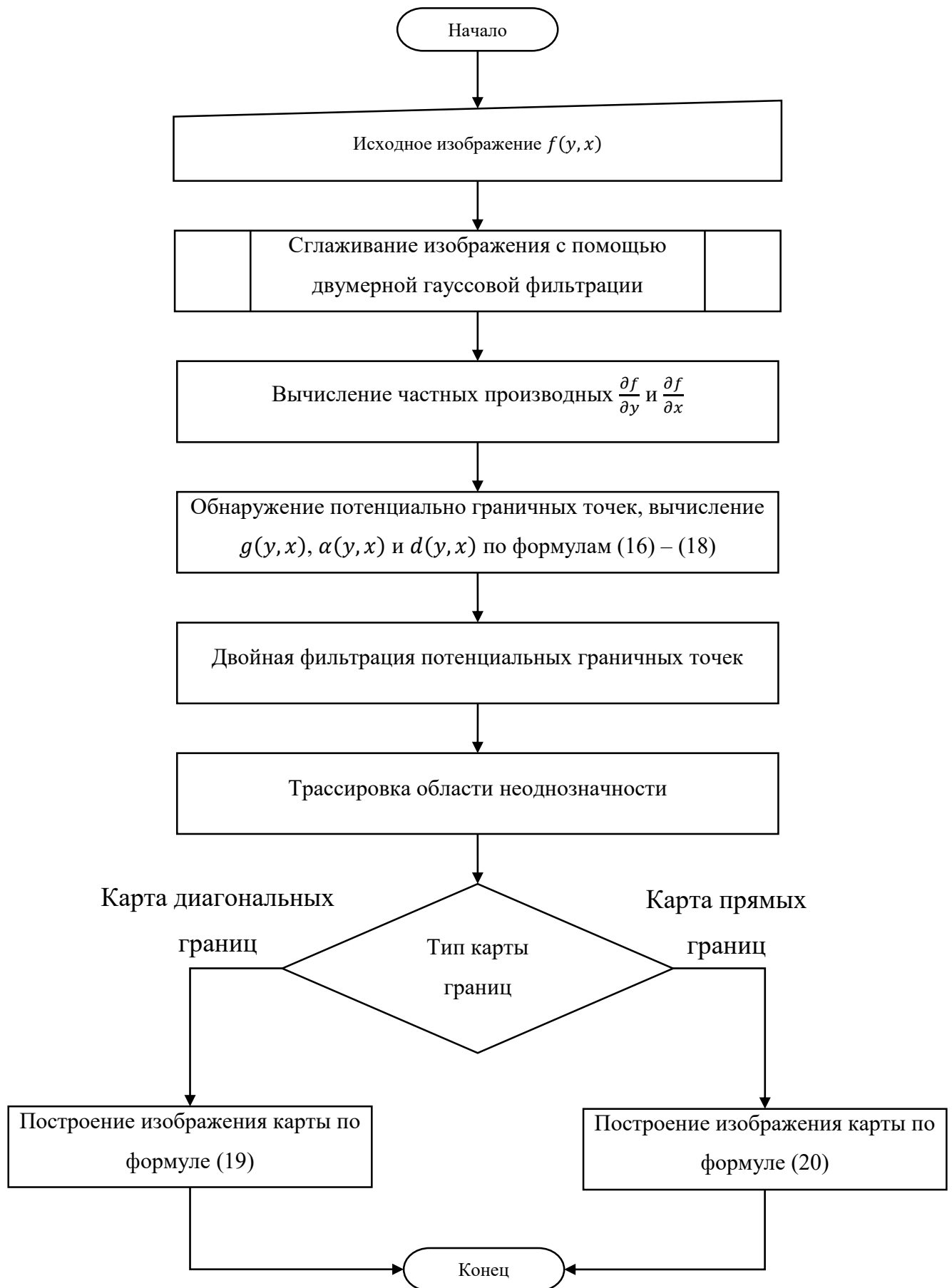
Рисунок 16 — Блок-схема алгоритма построения карты направленных границ
