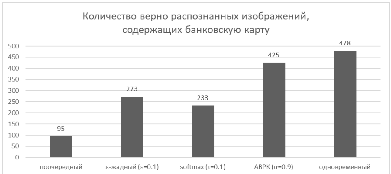
Рисунок 28 — Диаграмма количества верно распознанных изображений, содержащих банковскую карту с помощью различных методов
