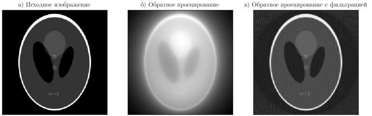
Рисунок 1.5 — Сравнение работы алгоритмов реконструкции “обратного проецирования” и “обратного проецирования с фильтрацией”.
