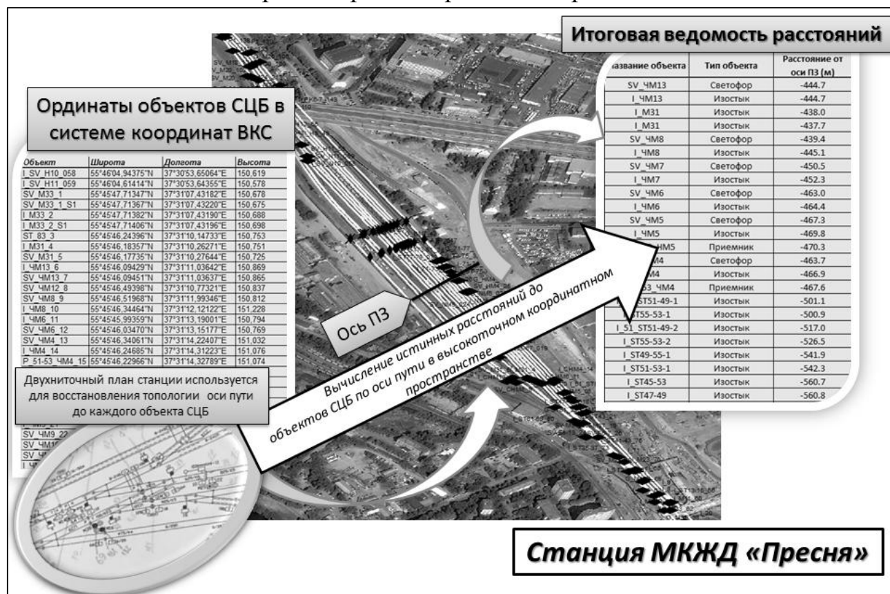
Рис.6 Формирование ведомости расстояний до объектов инфраструктуры (СЦБ), находящихся в пределах станции в системе координат ВКС.
