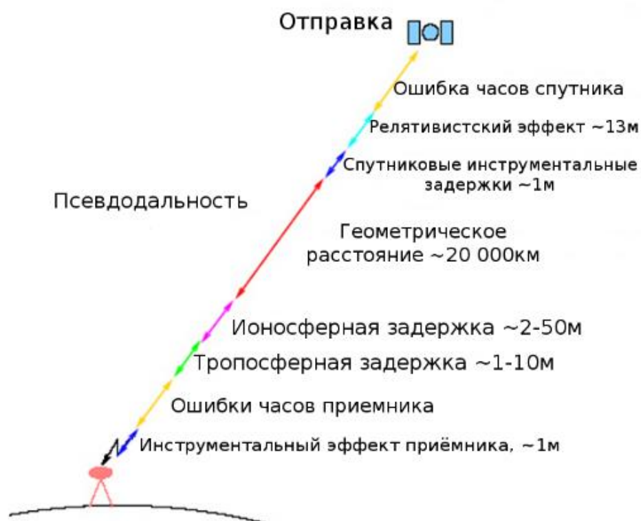
Рисунок 2.19. Ошибки, влияющие на вычислении траекторного решения
