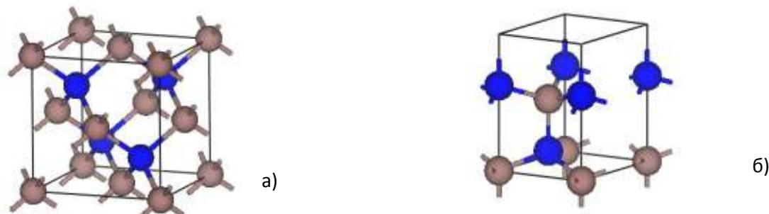
Рис. 2.21 InN и GaN в двух кристаллических решетках: а) сфалерит; б) вюрцит
