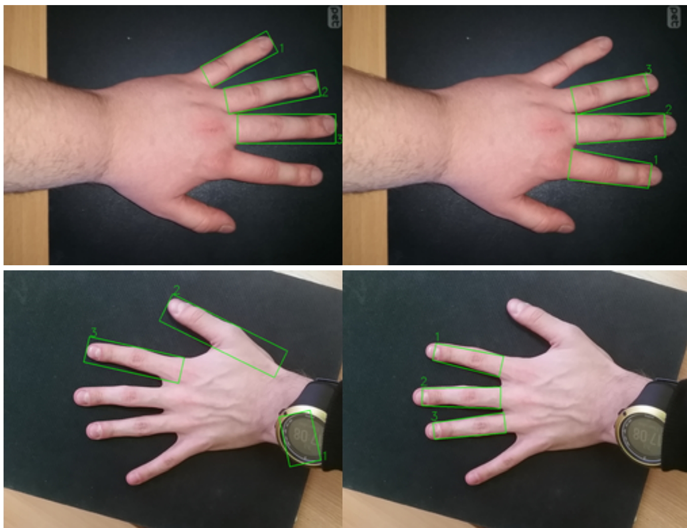
Рис. 11: Выделение трёх средних пальцев при «неидеальном контуре». Слева — метод, основанный на функции расстояния [37], справа — предложенный алгоритм, основанный на непрерывных скелетах. Нумерация пальцев начинается с большого пальца, имеющего индекс 0 (на рисунках не обозначен).
