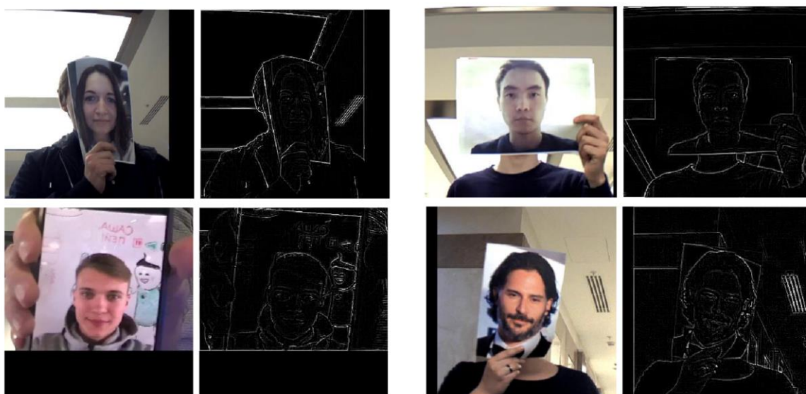
Рис. 3.6. Пример работы алгоритма выделения границ на поддельных изображениях.
