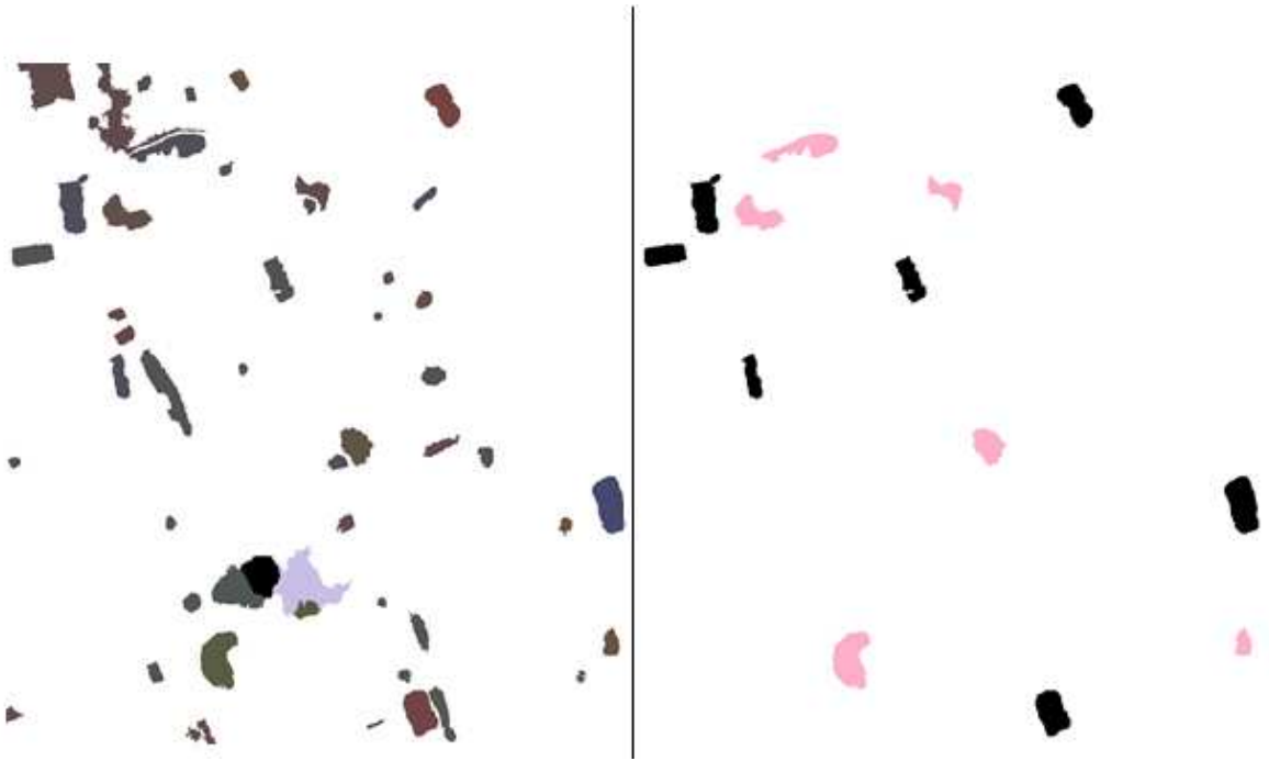
Рис. 2.9. Слева области после сортировки по площади, справа — после отбора по параметрам эквивалентного эллипса. Чёрные области — верно детектированные автомобили, розовые — ложные детектирования
