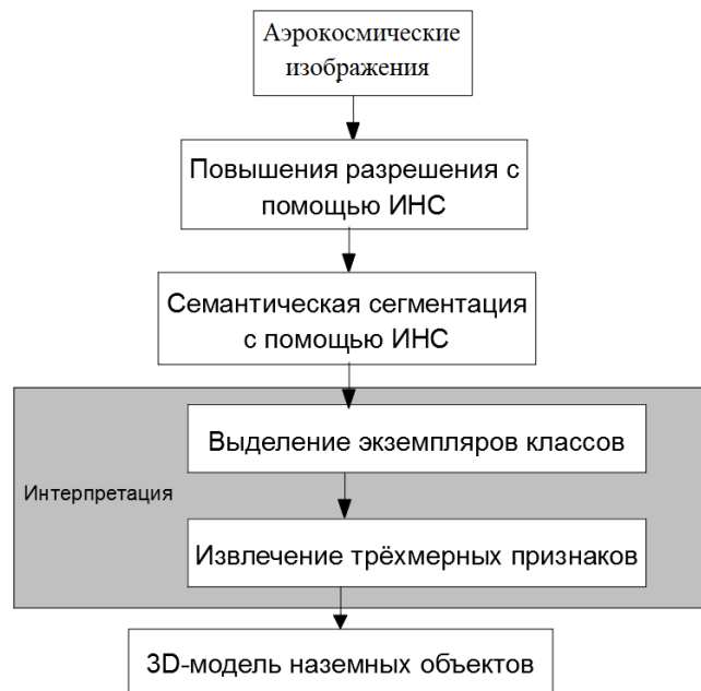
Рис. 3.15. Работа метода извлечения трёхмерной информации о наземных объектах инфраструктуры из спутникового изображения
