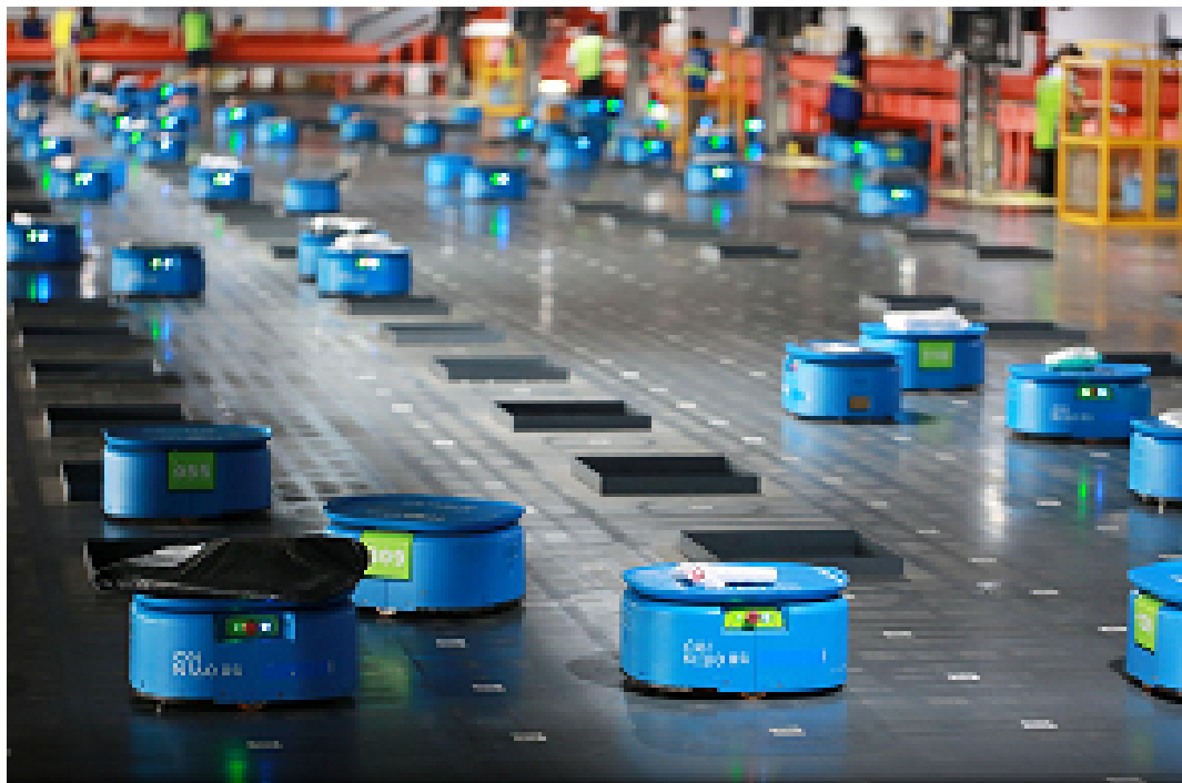
Рисунок 1.1 — Пример практического применения алгоритмов многоагентного планирования. Множество мобильных роботов заняты сортировкой товаров на складе компании Alibaba. Изображение взято из [19]
