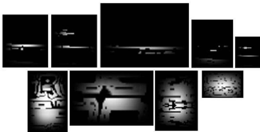
Рис. 2-21 Части регионов, в которых процентное соотношение белых пикселей от общего количества пикселей составляет до 25% (сверху) и от 65% (снизу), и которые будут отброшены
