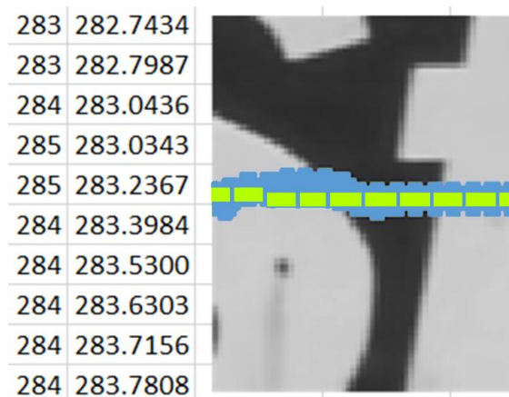
Рис. 4-11 Пример фильтрации измерений с выводом траектории движения объекта на соответствующий участок изображения (сплошная линия - результат фильтрации (значения округляются при выводе на изображение), пунктирная линия – данные измерений)
