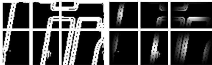
Рис. 2-19 Пример частей региона до (слева) и после обработки каждой части региона окном Ханна (Хеннинга) (справа)
