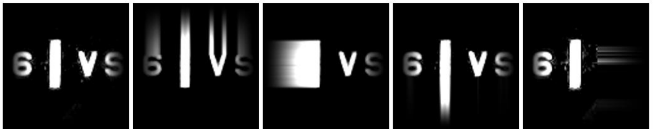
Рис. 3-28 Визуализация работы алгоритма отслеживания объектов при выходе объекта за границы кадра на 40% от его размера (длины или ширины) (слева направо: изображение объекта в границах кадра, копирование границ для верхней части изображения, левой, нижней и правой)
