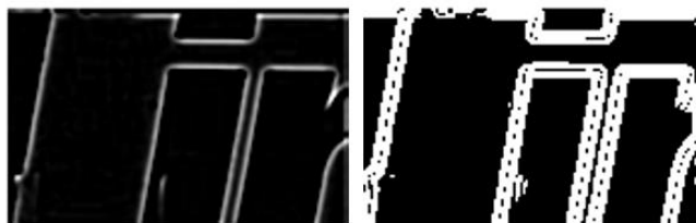
Рис. 2-14 Пример региона до (слева) и после порогового преобразования (справа)
