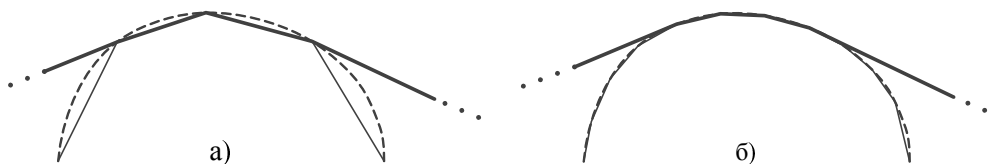
Рис. 3.17: Кратчайший путь, обходящий гладкое выпуклое препятствие. Время его обхода складывается из времени движения по прямолинейному отрезку, длина которого равна длине участка границы препятствия, и времени поворота из начальной ориентации к конечной.
